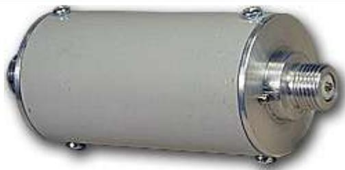
Блок искровой БИ-3 предназначен для получения высокого напряжения для розжига газового запальника и используется в качестве запальной свечи. БИ-3 устанавливается непосредственно в запальнике при помощи резьбового соединения. Блок выполнен в металлическом корпусе, в котором помещена электронная плата и высоковольтный трансформатор.
